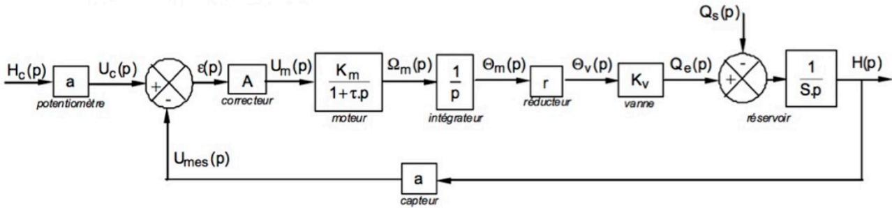
**Question 5 :** Déterminer les fonctions de transfert  $F_1(p) = \frac{H(p)}{H_c(p)} \Big|_{Q_s(p)=0}$  et  $F_2(p) = \frac{H(p)}{Q_s(p)} \Big|_{H_c(p)=0}$ .
