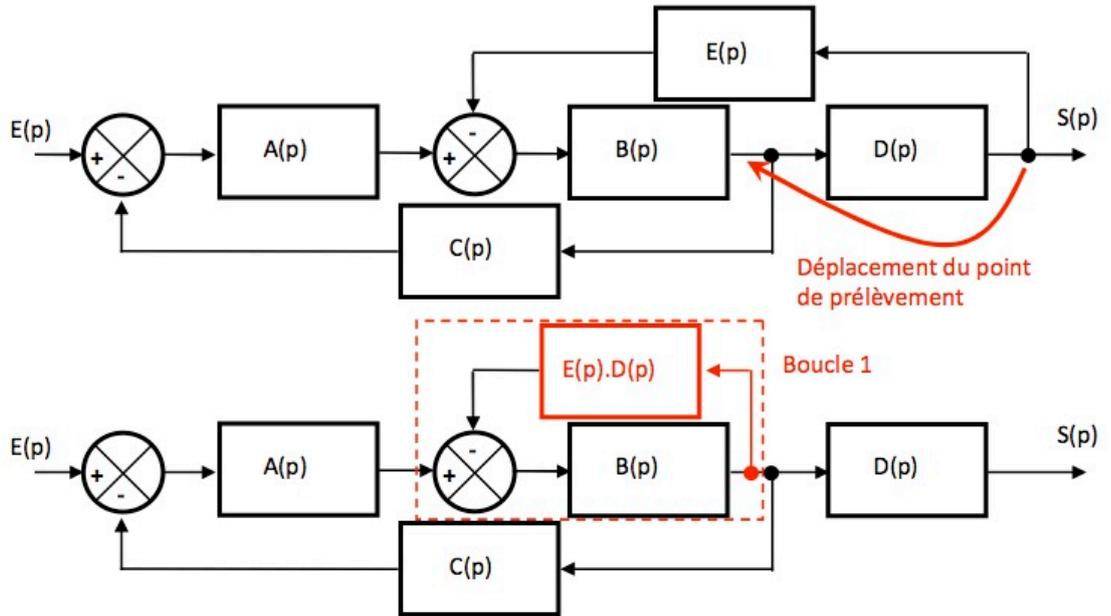
Calcul de la FBTF de la boucle 1 :  $H_1(p) = \frac{1}{E(p).D(p)} \cdot \frac{B(p).D(p).E(p)}{1 + B(p).D(p).E(p)} = \frac{B(p)}{1 + B(p).D(p).E(p)}$
