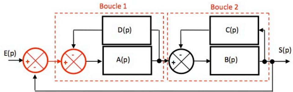
Calcul de la FBTF de la boucle 1 :  $H_1(p) = \frac{1}{D(p)} \cdot \frac{A(p) \cdot D(p)}{1 + A(p) \cdot D(p)} = \frac{A(p)}{1 + A(p) \cdot D(p)}$
