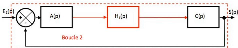
Calcul de la FBTF de la boucle 2 :  $H_2(p) = \frac{A(p).H_1(p).C(p)}{1 + A(p).H_1(p).C(p)} = \frac{A(p) \cdot \frac{B(p)}{1 + B(p)} \cdot C(p)}{1 + A(p) \cdot \frac{B(p)}{1 + B(p)} \cdot C(p)}$
