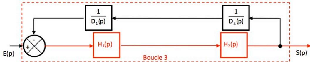
Calcul de la FBTF de la boucle 3 :  $H_3(p) = D_1(p).D_2(p) \cdot \frac{H_1(p).H_2(p)}{1 + \frac{D_1(p).D_2(p)}{H_1(p).H_2(p)}} = D_1(p).D_2(p) \cdot \frac{H_1(p).H_2(p)}{D_1(p).D_2(p) + H_1(p).H_2(p)}$
