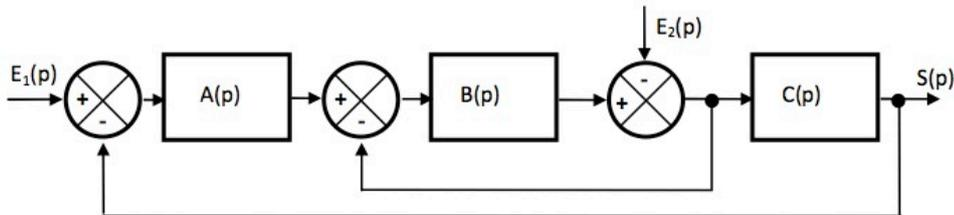
On utilise le théorème de superposition : on calcule les fonctions de transfert du système  $\frac{S(p)}{E_1(p)}$  pour  $E_2(p)=0$  et
