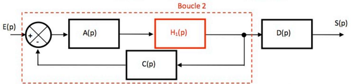
Calcul de la FBTF de la boucle 2 :  $H_2(p) = \frac{1}{C(p)} \cdot \frac{A(p).C(p).H_1(p)}{1 + A(p).C(p).H_1(p)} = \frac{A(p) \cdot \frac{B(p)}{1 + B(p).D(p).E(p)}}{1 + A(p).C(p) \cdot \frac{B(p)}{1 + B(p).D(p).E(p)}}$
