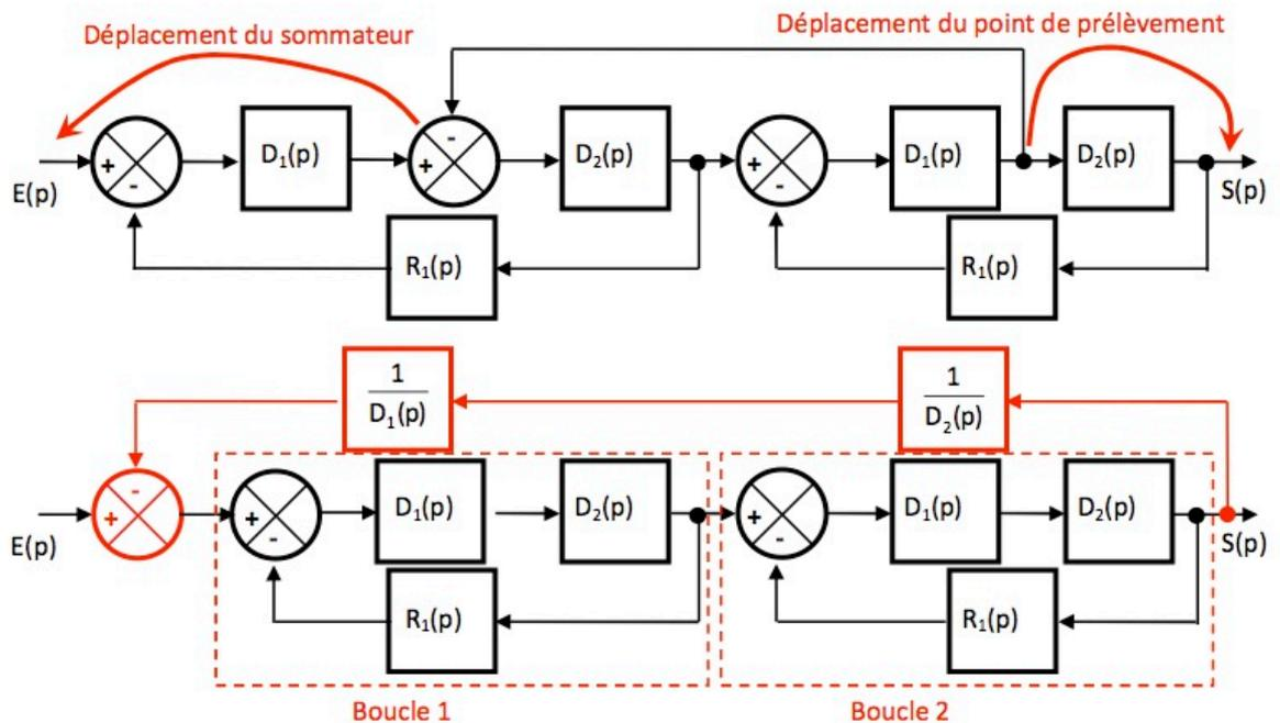
Calcul de la FBTF de la boucle 1 :  $H_1(p) = \frac{1}{R_1(p)} \cdot \frac{R_1(p) \cdot D_1(p) \cdot D_2(p)}{1 + R_1(p) \cdot D_1(p) \cdot D_2(p)} = \frac{D_1(p) \cdot D_2(p)}{1 + R_1(p) \cdot D_1(p) \cdot D_2(p)}$
