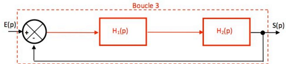
Calcul de la FBTF de la boucle 3 :  $H_3(p) = \frac{H_1(p) \cdot H_2(p)}{1 + H_1(p) \cdot H_2(p)} = \frac{\frac{A(p)}{1 + A(p) \cdot D(p)} \cdot \frac{B(p)}{1 + B(p) \cdot C(p)}}{1 + \frac{A(p)}{1 + A(p) \cdot D(p)} \cdot \frac{B(p)}{1 + B(p) \cdot C(p)}}$
