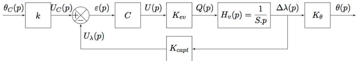
**Q16.** Déterminer l'expression de  $k$  en fonction de  $K_{cap}$  et  $K_\theta$  afin que le système soit correctement asservi.
