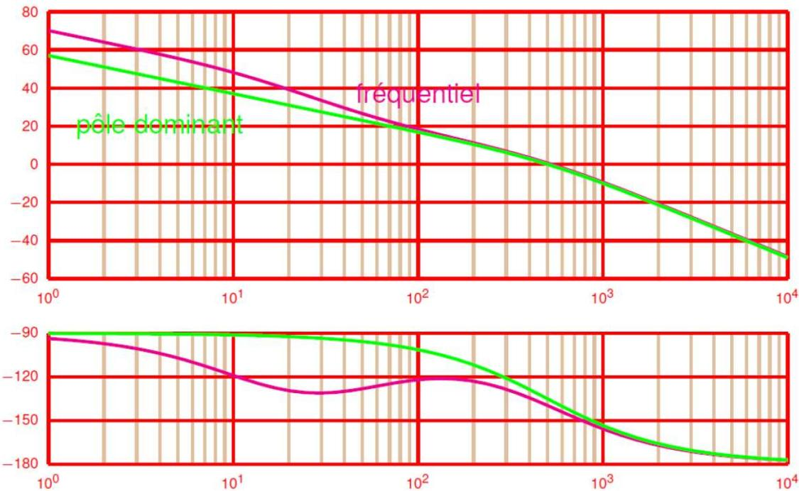
Lieu de Bode de la FTBO avec réglage du correcteur P.I. par méthode du placement fréquentiel et méthode de la compensation du pôle dominant
