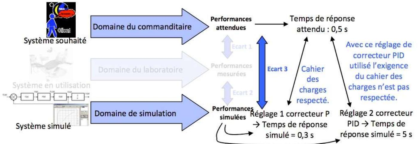
Résultats obtenus avec un logiciel de simulation (gratuit) : Easy Reg
