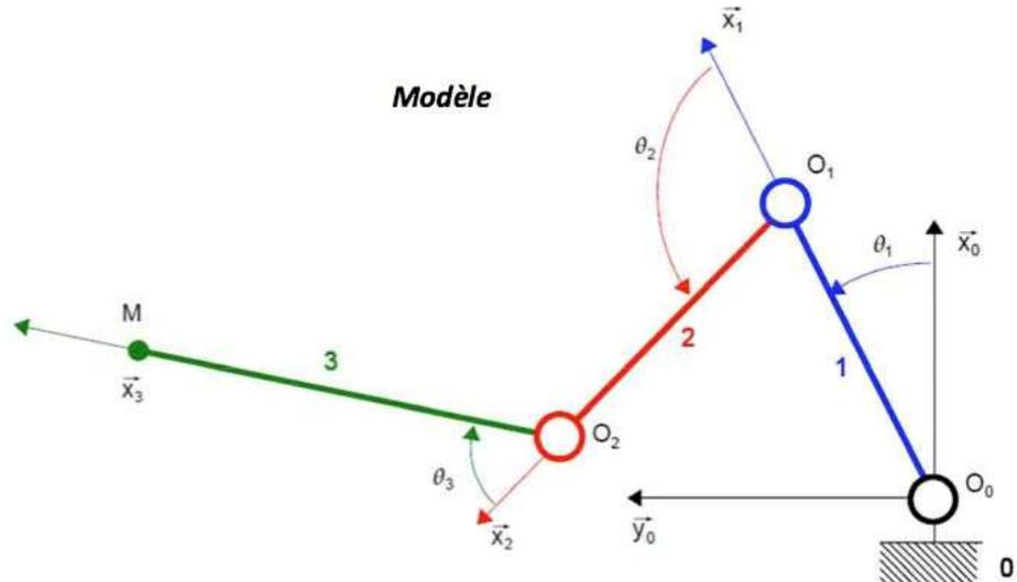
**Q.1.** Construire les figures planes de repérage/paramétrage puis exprimer les vecteurs vitesse instantanée de rotation  $\overrightarrow{\Omega}_{1/0}$ ,  $\overrightarrow{\Omega}_{2/1}$ ,  $\overrightarrow{\Omega}_{3/2}$ .
