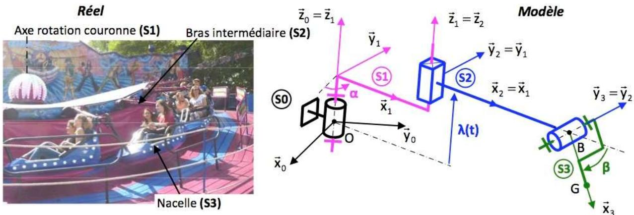
On considère que le système est constitué de quatre sous ensembles nommés (S0), (S1), (S2) et (S3) pour lesquels on associe un repère  $R_i$ . Chaque repère  $R_i$  possède la base notée  $b_i = (\vec{x}_i, \vec{y}_i, \vec{z}_i)$ .
