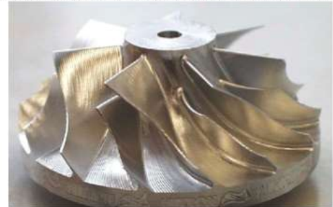
Exemple de pièce complexe obtenue par usinage
