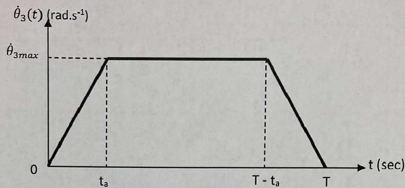
L'aire sous la courbe  $\dot{\theta}_3(t)$  correspond à l'angle parcouru par le bras (3) pour passer de la position horizontale à la position déployée  $\Rightarrow \Delta\theta_3 = 80^\circ = 80 \times \frac{\pi}{180} \text{ rad} = \frac{4\pi}{9}$
