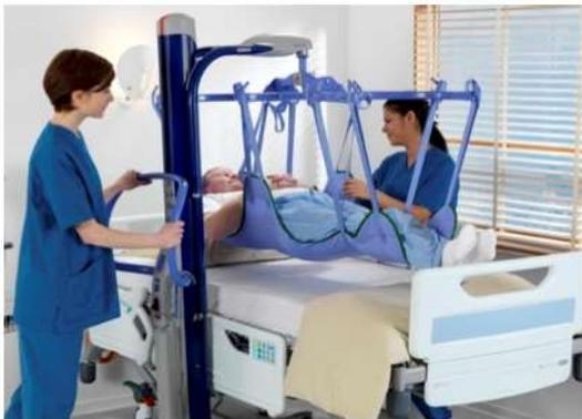
Un lève-malade, utilisé dans les maisons de retraites ou les hôpitaux, est une aide technique mécanisée qui sert à effectuer des transferts de personnes qui n'ont pas la capacité de se déplacer en autonomie.
