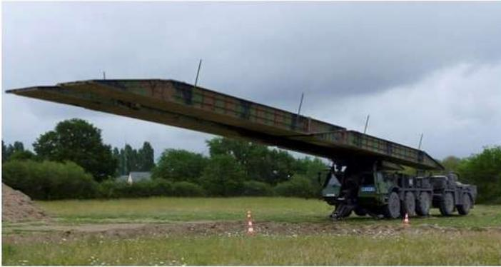
Le Système de Pose Rapide de Travures (SPRAT) est un improbable véhicule assurant la dépose rapide d'un pont permettant de franchir une brèche ou rivière de 25 m de large en moins de 10 min.
