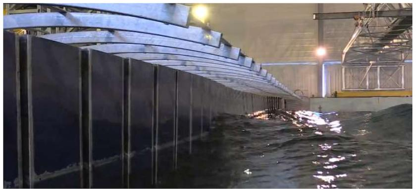
Figure 2 : Batteur à houle
