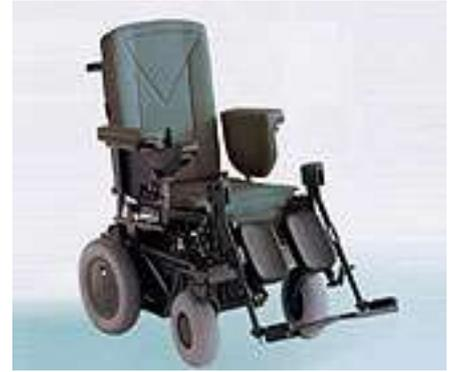
L'asservissement de vitesse et la commande de puissance des motoréducteurs (moteur + réducteur) sont effectués par une carte de commande envoyant un ordre à un variateur de vitesse.
