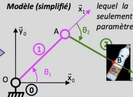
*On considère un modèle plan simple dans lequel la pince du robot est animée par seulement deux mouvements de rotation de paramètres  $\theta_1$  et  $\theta_2$ .*
