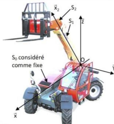
$S_0 = \{\text{roues, châssis, cabine}\}$
