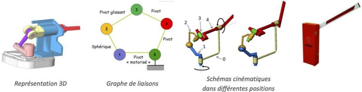
Le solide 1, animé d'un mouvement de rotation continue par rapport au bâti 0 grâce à un motoréducteur, permet la mise en rotation alternative du solide 4 sur lequel est fixée la lisse de la barrière.
