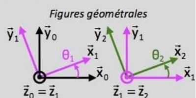
Le point B de la pince en bout de chaîne a pour coordonnées  $x_B$  et  $y_B$  dans le repère  $(O, \vec{x}_0, \vec{y}_0, \vec{z}_0)$ . Le modèle géométrique direct permet d'exprimer les coordonnées  $x_B$  et  $y_B$  en fonction des paramètres  $\theta_1$  et  $\theta_2$ . Le modèle géométrique indirect exprime les paramètres  $\theta_1$  et  $\theta_2$  en fonction des coordonnées  $x_B$  et  $y_B$ .
