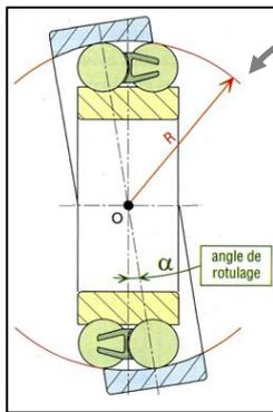
Il existe toujours un jeu, aussi minime soit-il, entre les billes et les bagues. Ce jeu a pour conséquence de permettre une rotation relative des bagues autour des axes perpendiculaires à l'axe de rotation principal du roulement.
