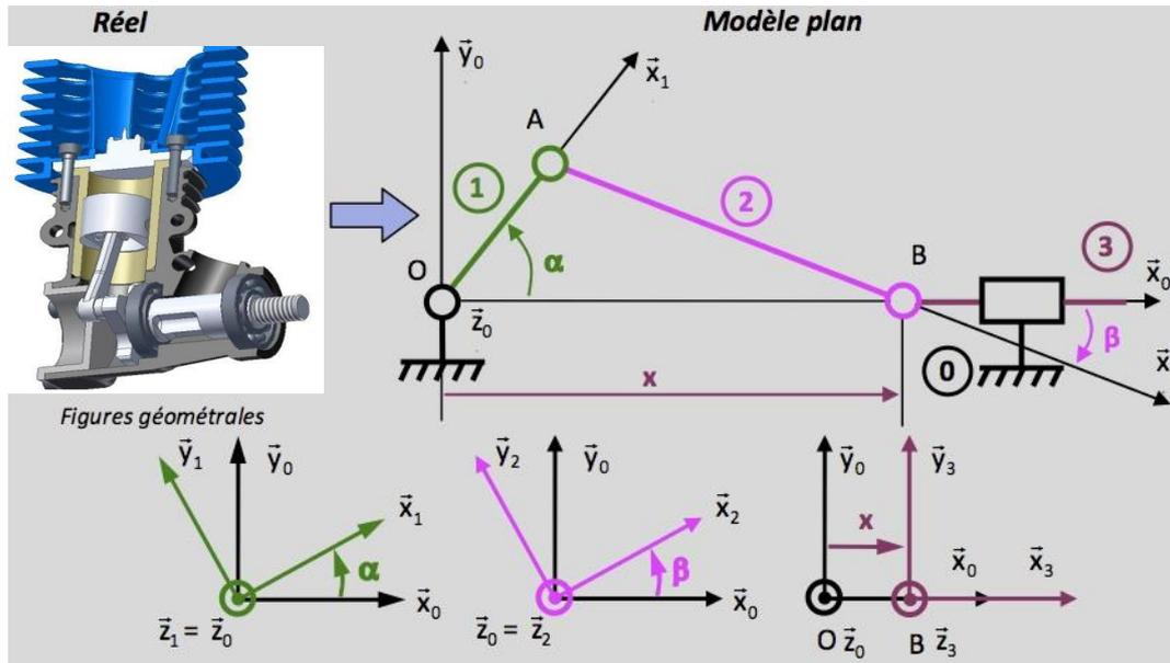
Le paramètre de sortie est  $\alpha$ , il traduit la rotation de la manivelle 1 par rapport à 0 autour de l'axe  $(O, \vec{z}_0)$ . Le paramètre d'entrée est  $x$ , il traduit la translation du piston 3 par rapport à 0 suivant  $\vec{x}_0$ . Le paramètre  $\beta$  est un paramètre intermédiaire qui traduit la rotation de la bielle 2 par rapport à 0 autour de l'axe  $(B, \vec{z}_0)$ .
