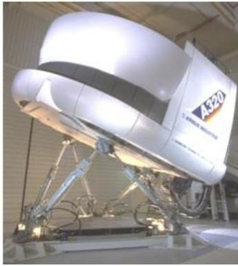
Les plates-formes mobiles, qui font partie des robots dits « parallèles », sont des systèmes constitués d'un plateau mis en mouvement par 6 vérins électriques ou hydrauliques.
