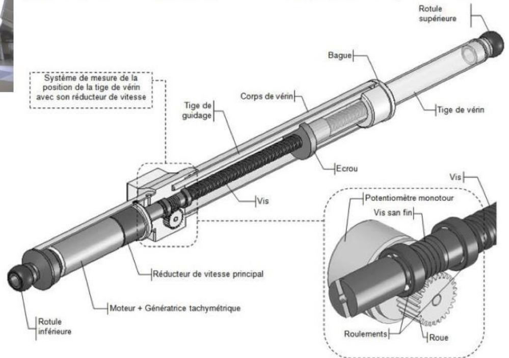
On s'intéresse au système en **boucle ouverte**, constitué du moteur et du capteur de vitesse (génératrice tachymétrique), d'un axe de la plateforme du laboratoire.
