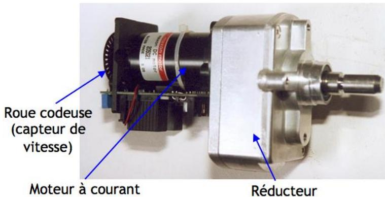
On s'intéresse au moteur entraînant la pompe péristaltique qui permet d'aspirer et de refouler dans le dialyseur, le sang du patient.
