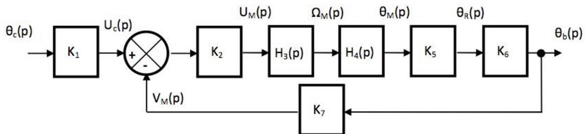
Avec :  $K_1, K_2, K_5, K_6, K_7$  : constantes,  $\theta_c(p)$  : angle de consigne,  $U_c(p)$  : tension consigne,  $U_M(p)$  : tension moteur,  $\Omega_M(p)$  : vitesse angulaire de l'arbre moteur,  $\theta_M(p)$  : angle de l'arbre moteur,  $\theta_R(p)$  : angle de l'arbre en sortie de réducteur,  $\theta_b(p)$  : position angulaire du bras,  $V_M(p)$  : tension mesurée image de  $\theta_b(p)$ .
