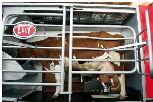
Figure 2 : Vache en phase de traite et d'alimentation dans le box du robot de traite LELY
