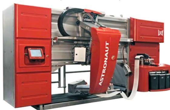
Figure 1 : Le robot de traite LELY ; le box présenté figure 2 se trouve à l'arrière
