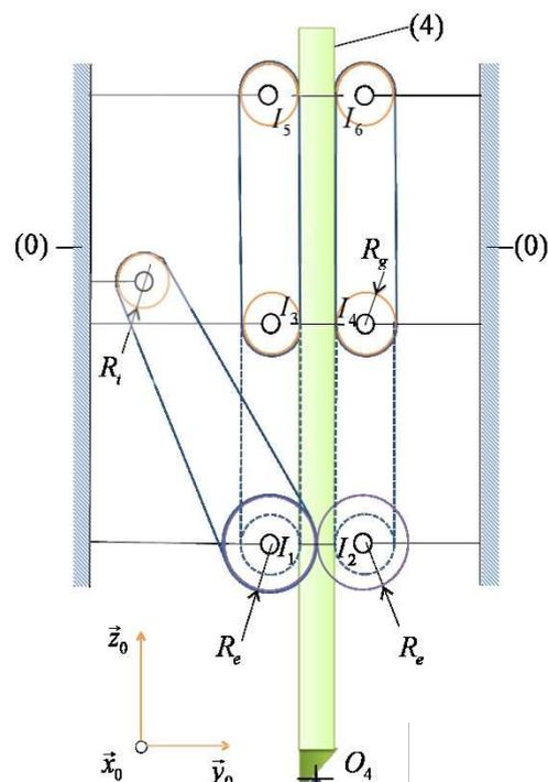
La transmission de mouvement entre le galet 1 et le galet 2 se faisant par un engrenage dont les pignons ont le même rayon primitif, ces 2 galets ont la même vitesse de rotation  $\omega_e$ .
