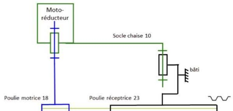
Or  $\omega_{23/\text{bâti}} = 0$ , donc  $\omega_{10/\text{bâti}} = -r \cdot \omega_{18/10} = -0,3 \times 50 = -15 \text{ tr/min}$  : le robot tourne autour de l'axe de lacet dans le sens opposé au moto-réducteur.
