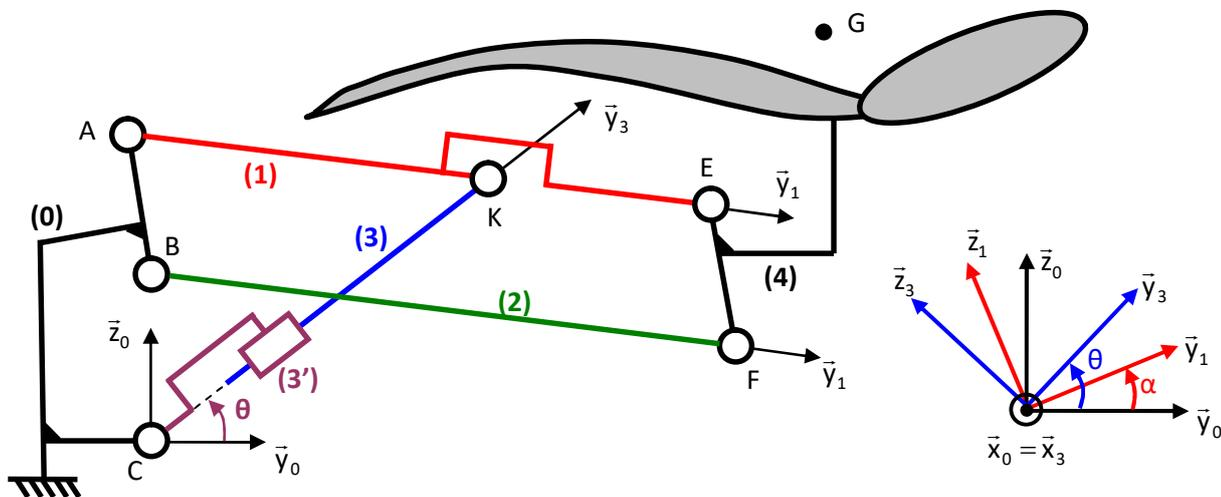
On considère sur ce modèle qu'il y a des liaisons pivots d'axe  $\vec{x}_0$  aux points A, B, C, E, F, K.
