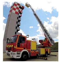
On s'intéresse à une Echelle Pivotante Automatique à commande Séquentielle (EPAS).
