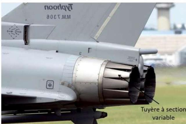
La tuyère à ouverture variable montée en sortie du turboréacteur, en aval de l'écoulement, a pour fonction de faire varier la section de la veine de fluide en sortie.
