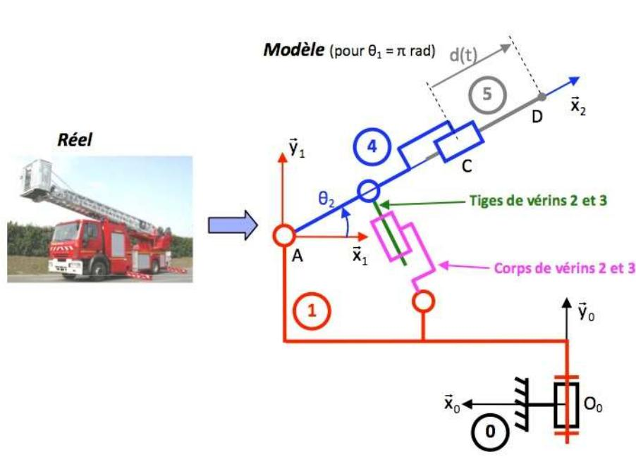
**Q.3.**  $\overrightarrow{O_0D} = \overrightarrow{O_0A} + \overrightarrow{AC} + \overrightarrow{CD} = -b\vec{x}_1 + a\vec{y}_1 + c\vec{x}_2 + d(t)\vec{x}_3$ , avec :
