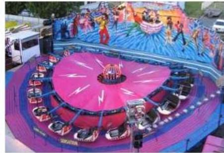
Ce type d'attraction permet de procurer des sensations importantes aux passagers, à la fois en marche avant et en arrière par un mouvement de « brassage ». L'ensemble tourne à une vitesse maximale de 14 tours/min. Les voitures sont suspendues par le haut et peuvent basculer de gauche à droite à chaque dos d'âne. Au plus haut de ces bosses, les nacelles se retournent quasiment « à l'envers ».
