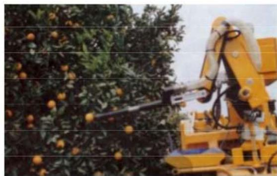
Le bras 1 tourne autour de l'axe  $(O_0, \vec{z}_0)$  par rapport au bâti 0. Le bras 2 tourne autour de l'axe  $(O_1, \vec{z}_0)$  par rapport à 1. Le bras 3 tourner autour de l'axe  $(O_2, \vec{z}_0)$  par rapport à 2.
