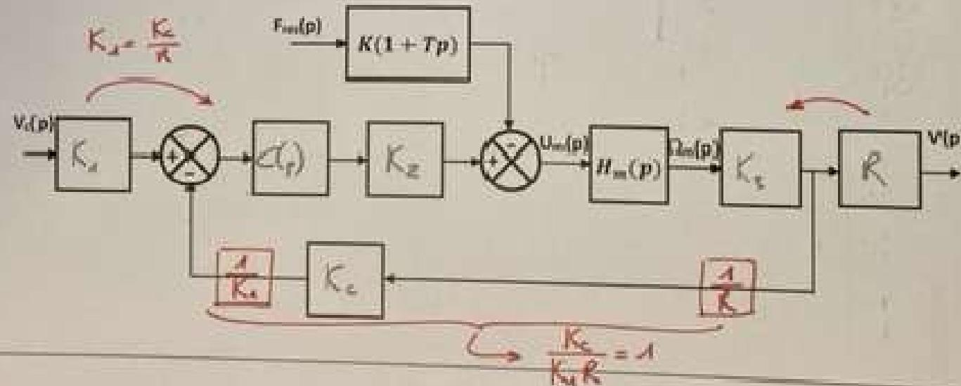
Justification de la forme du nouveau schéma bloc avec perturbation décalée en amont du moteur :
