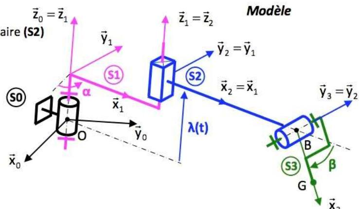
Le solide (S1) qui correspond à la couronne centrale du manège est en liaison pivot d'axe  $(O, \vec{z}_0)$  avec le bâti (S0). On pose  $\alpha = (\vec{x}_0, \vec{x}_1) = (\vec{y}_0, \vec{y}_1)$ .
