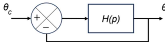
Figure 9 - Schéma équivalent de l'asservissement de l'axe d'inclinaison
