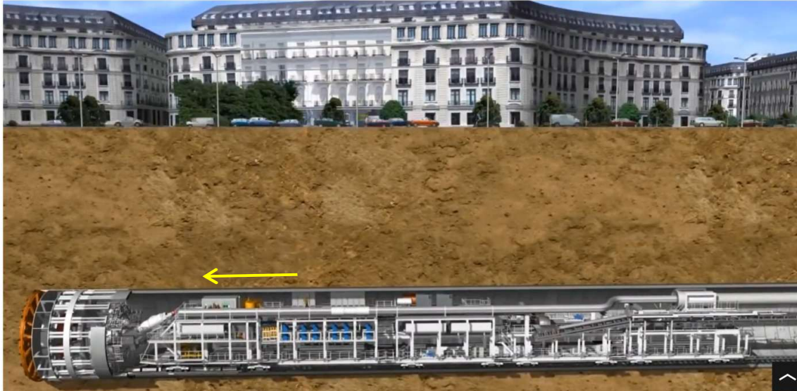
Fig.1. Avancée du tunnelier en milieu urbain dense
