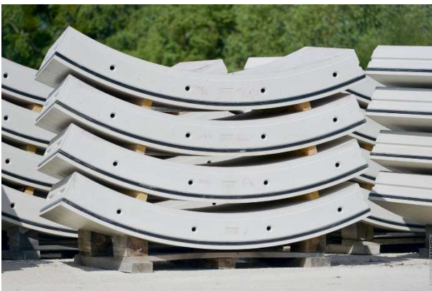
Fig. 6 Voussoirs préfabriqués et entreposés avant livraison
